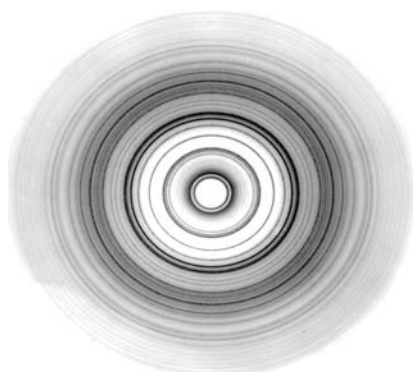
Рис. 1. Электронограмма поликристаллической пленки оксида цинка ZnO Расстояние «сопло-пластинка» L=500 мм, длина волны электронов – 0.0486608 Å
